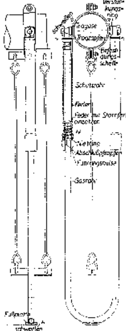
Bild 19a — Pendelstütze der Bauart Weimischke über Fahr-Sig. Heerke
