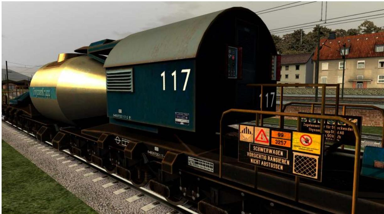
Sind Spezialwaggons, mit denen flüssiges Roheisen vom Hochofen zur Gießerei transportiert wird. Durch ihre doppelte Schamott-Isolierung kann das Eisen bis zu 30 Stunden lang bei einer Temperatur von ca. 1.400 Grad Celsius flüssig gehalten werden. Da diese Waggons aggressiven Substanzen bei einer hohen Temperatur ausgesetzt sind, altern sie sehr schnell und sind bereits nach kurzer Zeit mit einer Rostschicht bedeckt.
