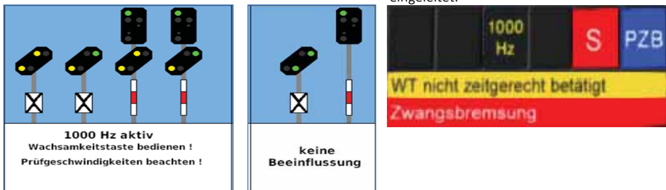
Abbildung 15 – Signale und Information im MFA - PB-Leuchtmelder über eingeleitete Zwangsbremung
