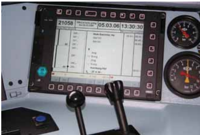
Abbildung 21 – EBUa-Bordgerät auf dem Führerstand der BR185
