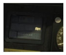
Le passage en freinage rhéostatique déclenche la remise à zéro du régulateur.
