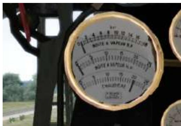
L'aiguille du bas donne la pression de la chaudière : notez le trait rouge à 20 bars à laquelle se déclenche la 1ère valve de sécurité (la 2ème se déclenche à 20,1 bars)
