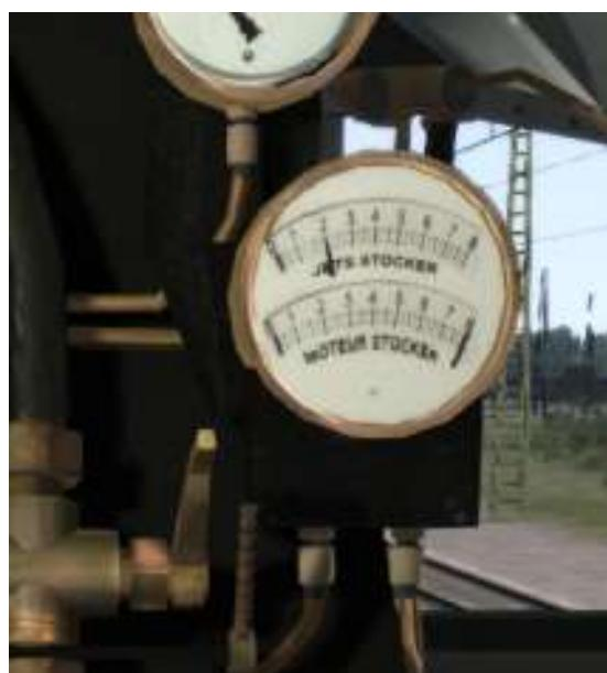
L'aiguille « moteur stoker » monte vite au maximum : le robinet envoie la vapeur qui active la vis sans fin du stoker.
