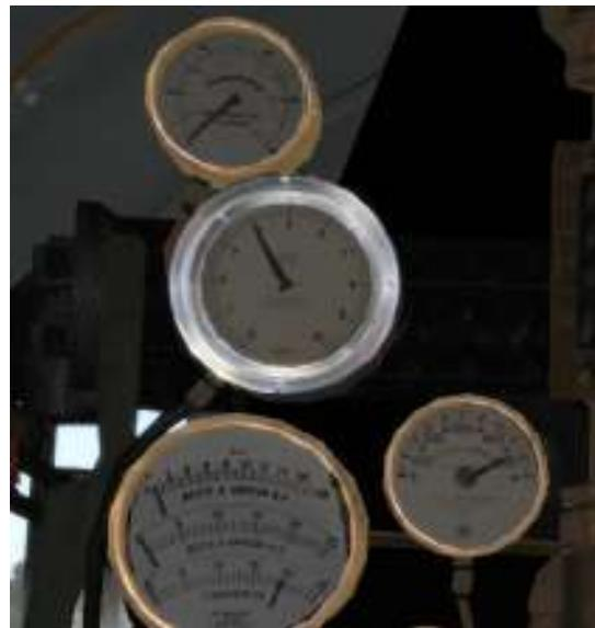
Au milieu (gris argent), le manomètre de Contre-pression à l'échappement qui permet de surveiller le tirage obtenu par l'échappement. L'information est calculée approximativement par script faute de données du simulateur. Autrement dit, pas nécessaire pour la conduite.
