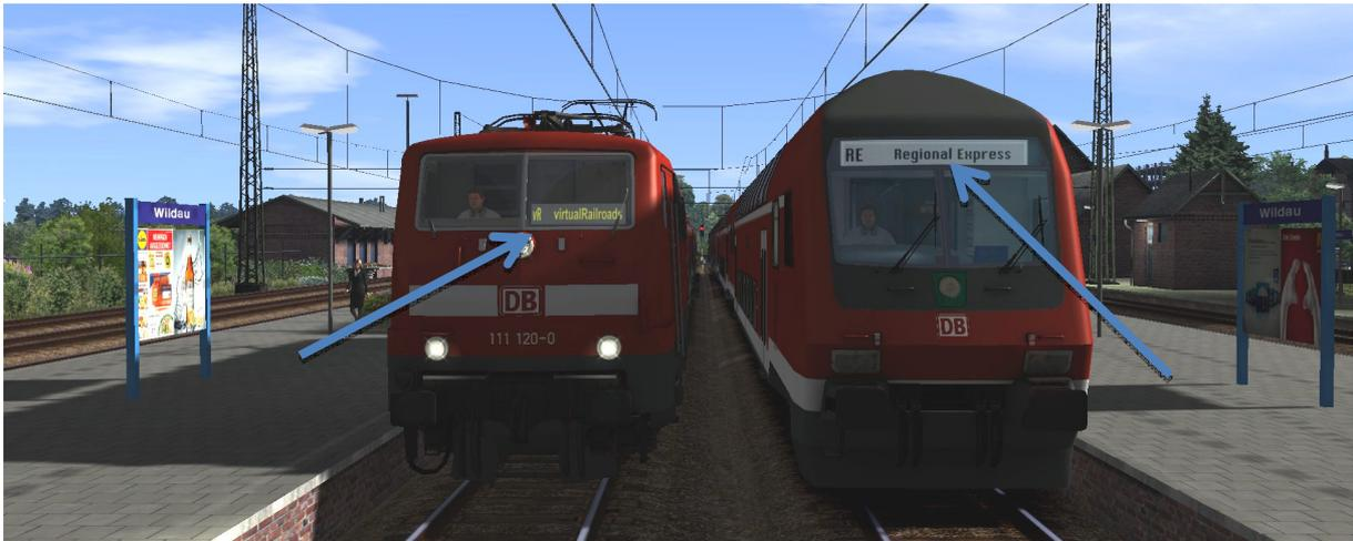
Die Lokomotive und der Steuerwagen sind mit einer schaltbaren und selbstleuchtenden Zugzielanzeige ausgestattet. Die ZZA verfügt über eine Anzeige für die Fahrtziele und eine zusätzliche Linienanzeige am Anfang. Es sind eigene Fahrziele einstellbar. Wir haben die nützlichsten Fahrtziele für diesen Zugverband bereits eingearbeitet.
