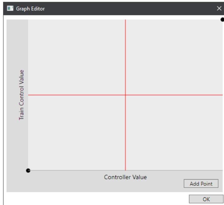
Die graue Linie (am Bild ganz unten) entspricht dem Nullpunkt, die zwei Roten entsprechen jeweils dem aktuellen Wert am Controller und dem aktuellen Wert im Führerstand.
