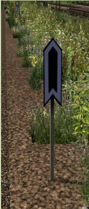
In einigen Bahnhöfen sind an den Ausfahrten sogenannte „Zs10“ Tafeln verbaut. Diese zeigen ein Ende der Geschwindigkeitsbeschränkung an.
