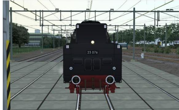
Unsere 23-er ergibt die beste Leistung wenn Sie die Steuerung auf 21 % und der Regler auf 58 % hochziehen. Es gibt mehr Spass als die Lok ohne *Auto Fireman* gefahren wird. Es ist dabei wichtig dass der Wasserstand im Kessel in der Nähe von 99 % und die Kohlemenge um 65 % gehalten werden.
