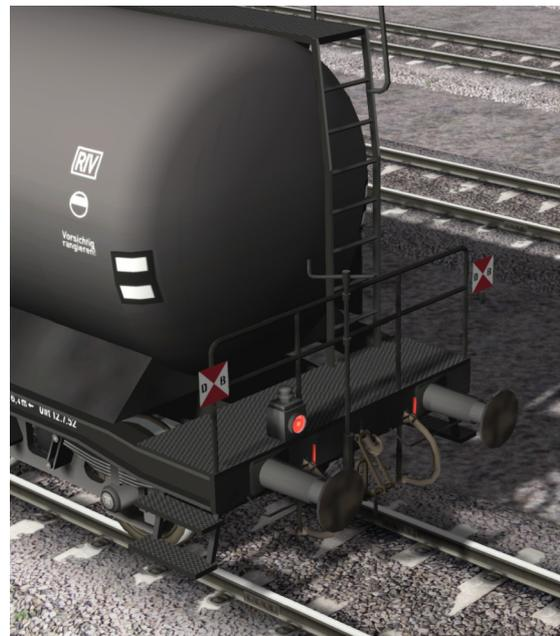
Ausser in den Anschriften und Kesselfarben gibt es innerhalb die WG ZZw-Kesselwagen Unterschiede in das Vorhandensein bzw. Fehlen von einem Bremserhaus. Abhängig von der Bahngesellschaft werden auf den letzten Wagen DB-, NS- oder DR-Zugschlussschilder gezeigt.
