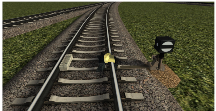
SBS_Gleissperre_R-e Nach rechts entgleisend für ferngestellte Gleissperren
