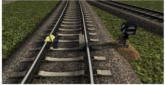
SBS_Gleissperre_L-e Nach links entgleisend für ferngestellte Gleissperren
