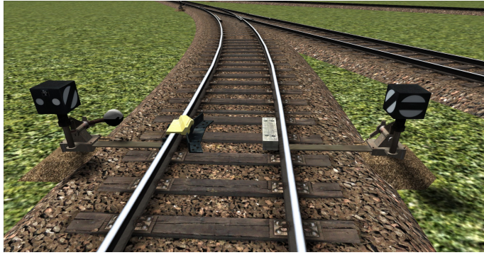
SBS_Gleissperre_L-d Nach links entgleisend für handgestellte Gleissperren
