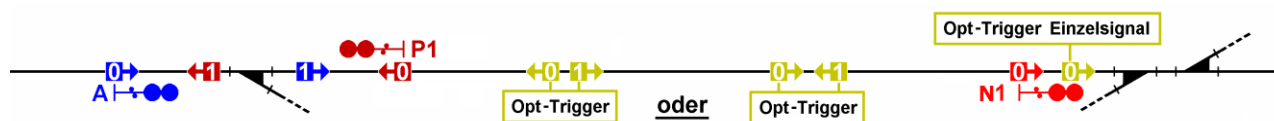
Die Lage der Links in 2 Varianten (gilt für beide Opt-Trigger mit 2 Links)
