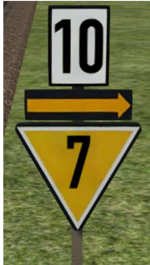
Abbildung 29 - zwei Langsamfahrsignale an einem Mast
