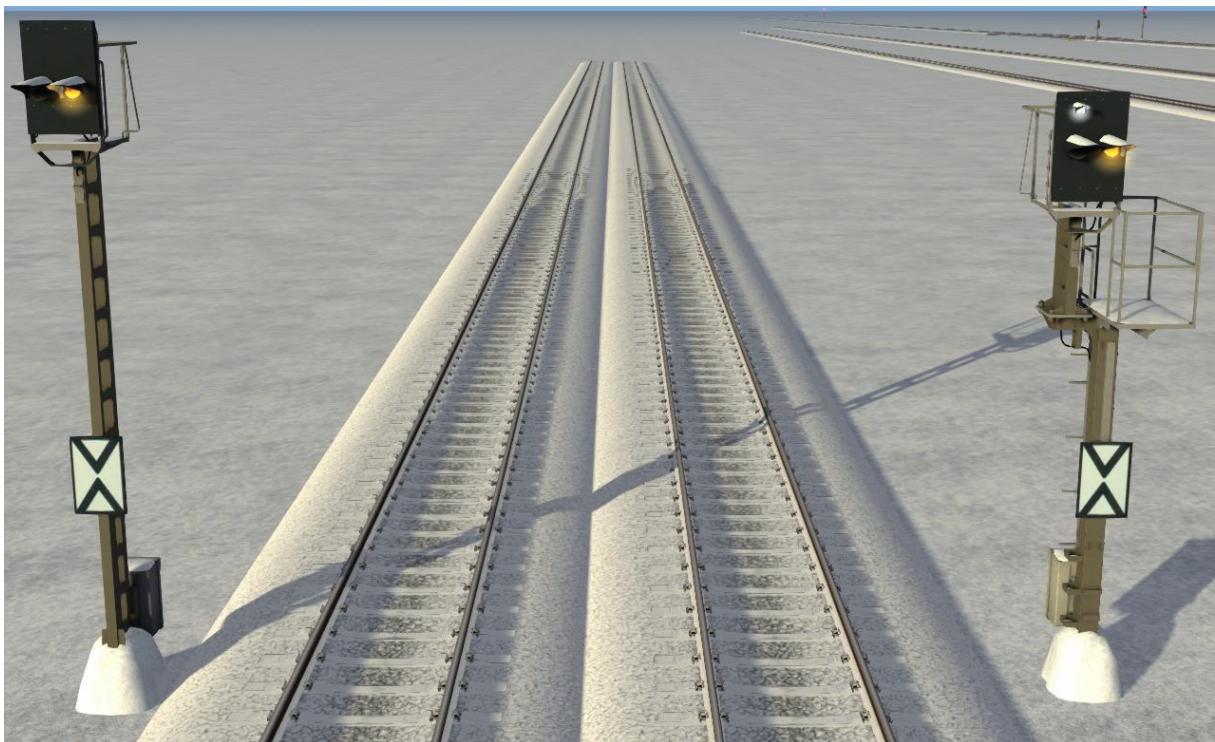
Abbildung 6 - Vorsignale in alter und neuer Ausführung
