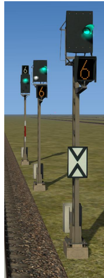
Abbildung 8 - Abfolge von Signalen mit LED Technik
