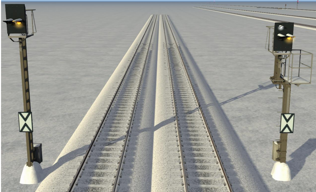
Abbildung 5 - Vorsignale in alter und neuer Ausführung
