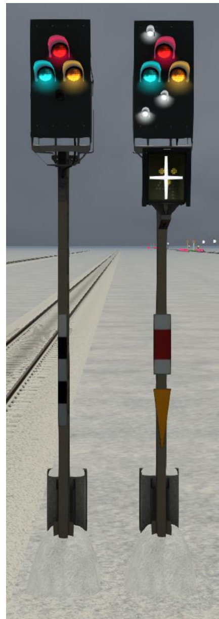
Abbildung 4 - zwei Signale der Sonderbauform für die S-Bahn Berlin
