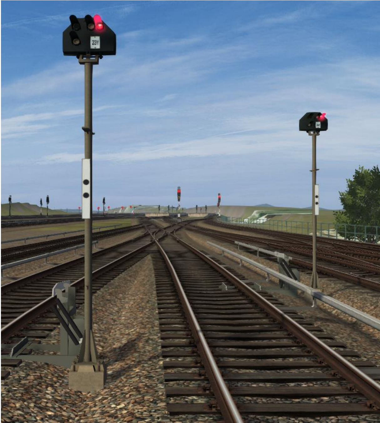
Abbildung 18 - Lichtsperrsignale bei der S-Bahn Berlin
